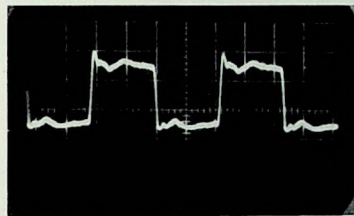
Bild 2 (oben). Einschwingvorgänge und Kurvenformverzerrungen des „M 15“ bei 1 p Tonarmauflagekraft, kontrolliert an einer rechteckförmigen Ausgangsspannung bei der Abtastung einer dreieckförmigen Rillenauslenkung
